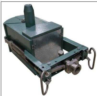
Коробчатый автоматический дночерпатель «ДАК» предназначен для взятия донных проб в пресноводных водоемах на мягких и средней плотности грунтах с любых плавательных средств.
