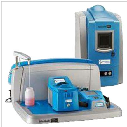
Лаборатории MiniLab предназначены для анализа масел и смазок, применяемых в различном промышленном оборудовании и транспорте. Анализ масла помогает выявить первые признаки износа оборудования. Лаборатории MiniLab позволяют проводить анализ масел на рабочем месте, что существенно экономит время и позволяет незамедлительно принимать решения, что приводит к:
