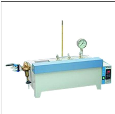
Позволяет одновременный анализ 3 образцов топлив на содержание растворенных смол с целью оценки количества смолистых отложений во впускных трактах, форсунках, на поршнях и клапанах двигателей при применении данного топлива.
