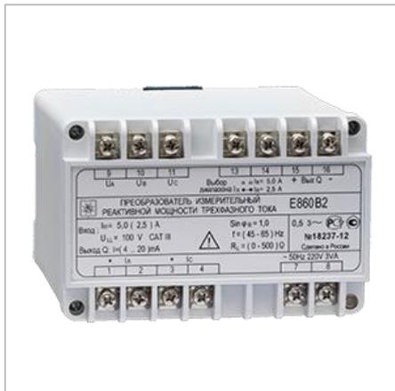
Преобразователи E860 предназначены для линейного преобразования реактивной мощности трехфазных трехпроводных цепей переменного тока в унифицированные выходные сигналы постоянного тока. Могут применяться в системах автоматического регулирования и управления объектов электроэнергетики и различных отраслей промышленности, для контроля текущих значений реактивной мощности.
