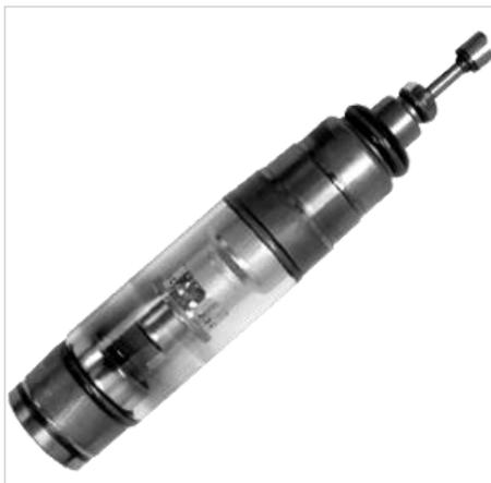
Ускорительная нейтронная трубка Ж83-Р919 (ИНТ) предназначена для генерации потока нейтронов энергией около 14 МэВ с частотой до 30 имп/с.
