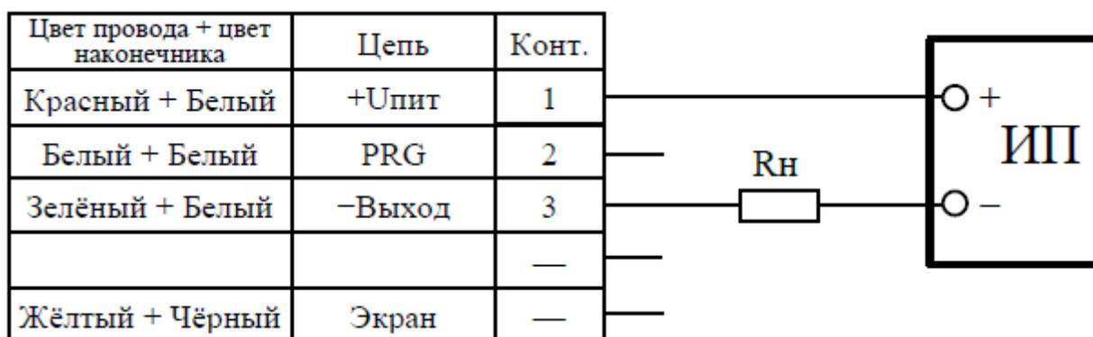
б) Соответствие назначения выводов разъема цветовой маркировке проводов кабеля (исполнения 91, 92)
