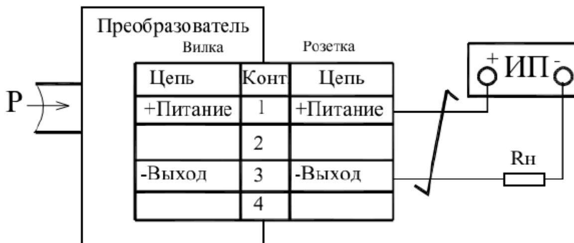
Рис. 19. Схема включения преобразователей СДВ-Ех и СДВ-ЕхР
