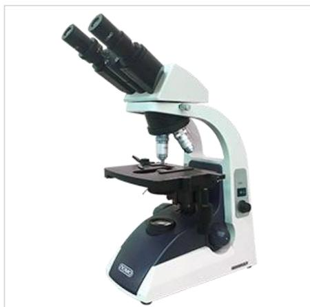
Медицинский микроскоп МИКМЕД-5 предназначен для клинической лабораторной диагностики и обеспечивает наблюдение объектов в проходящем свете при освещении по методу светлого поля.
