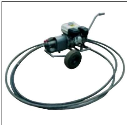
Автономная бензогидравлическая установка «Ураган» служит для гидромеханического разрушения илистых и иных отложений на внутренней поверхности труб канализационных трубопроводов вращающимся инструментом с последующим удалением потоком жидкости.
