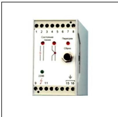
Блок тепловой защиты БТЗ защищает от перегрева обмоток двигателей как при медленно нарастающих, так и быстро нарастающих тепловых перегрузках. При обрыве фазы или коротком замыкании БТЗ отключает двигатель.
