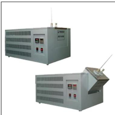
Аппарат АТЗ-70-ПХП применяют для определения низкотемпературных характеристик и тестирования нефтепродуктов по методике ГОСТ 20287, ГОСТ 5066, а также ASTM D97, ASTM D 2500.
