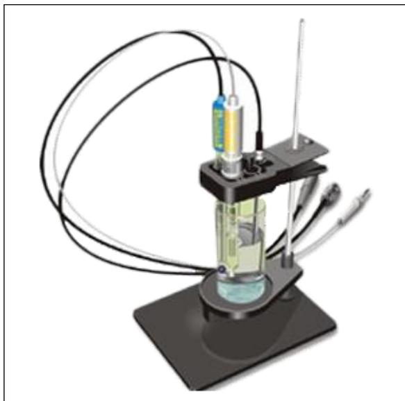
Штатив универсальный ШУ-05 предназначен для крепления измерительных и электродов сравнения, автоматических термокомпенсаторов (термодатчиков), термометров и других устройств при проведении лабораторных анализов растворов.
