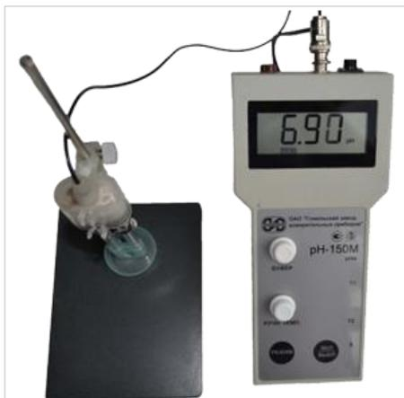
Портативный рН-метр-милливольтметр рН-150М предназначен для оперативного измерения активности ионов водорода (рН), окислительно-восстановительных потенциалов (Еh) и температуры технологических растворов, природных и сточных вод.
