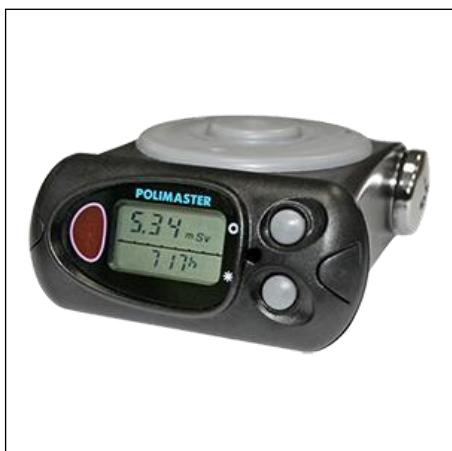
Предназначены для измерения индивидуальной эквивалентной дозы Нр(10) (ЭД) и мощности индивидуальной эквивалентной дозы Нр(10) (МЭД) гамма и рентгеновского излучений в пределах от значений естественного фона до 0,1 Зв/ч (ДКГ-РМ1621) и до 1 Зв/ч (ДКГ-РМ1621А) в энергетическом диапазоне от 10 кэВ до 20 МэВ.
