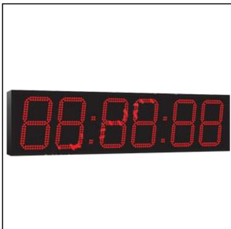
Электронные часы для эксплуатации в помещениях в формате "HMS" отображают попеременно данные о текущем времени и даты в формате " часы : минуты : секунды " и " день: месяц : год". Продолжительность отображения каждого параметра можно настроить с помощью пульта ДУ на ИК лучах. Настенные электронные часы "Импульс" для помещений и офисов - односторонние, также возможно изготовление двусторонних часов.
