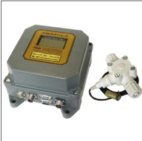
Анализатор предназначен для измерения удельной электрической проводимости (в дальнейшем УЭП) или условной концентрации растворенных веществ в пересчете на NaCl (в дальнейшем - условной концентрации) воды и водных растворов, автоматического приведения результатов измерения к температуре +25°С, их цифровой индикации и преобразования результатов измерения в стандартный выходной токовый сигнал и стандартные выходные цифровые интерфейсные сигналы.
