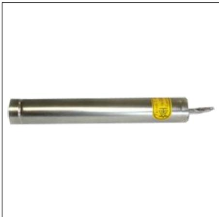
Предназначен для высокоэффективной регистрации нейтронного излучения в физических и радиометрических устройствах, в порталных радиационных мониторах, в аппаратуре регистрации нейтронной составляющей космического излучения.
