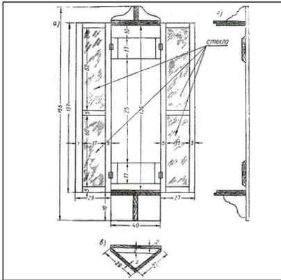
Барометрический шкафчик устанавливается в рабочем помещении метеорологической станции и предназначается для установки в нем стационарного барометра.
