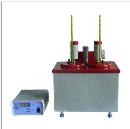
Аппарат предназначен для проведения испытания по методике ГОСТ 19199-73. «Масла смазочные. Метод определения антикоррозионных свойств.»
