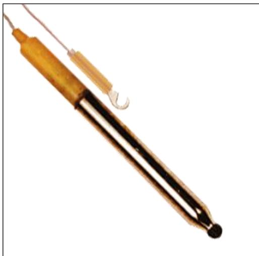
Электрод ЭО-01 предназначен для измерения окислительных потенциалов жидких сред.
