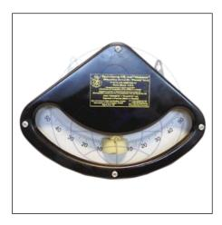
Кренометр КМ предназначен для измерения угла крена судна. Может использоваться на судах любого класса и района плавания.
