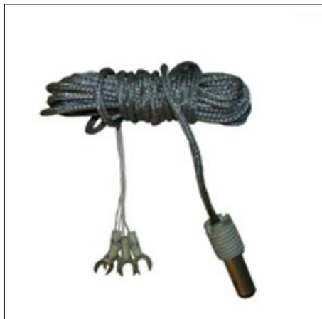
Допускается по спец.изготовлению с поверкой ТСМ/ТСП1193-01М; 02М; 03М; ТСП-1193-04М – то же, что ТСМ/ТСП-1193-01; 02; 03; ТСП-1193-04, но с кабелем КММФЭ-4\*0,12 со степенью защиты IP65.
