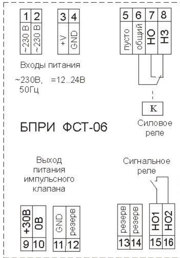
Рисунок. 5.2 Монтажные клеммы
