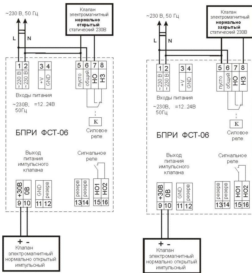
Рисунок. 5.3 Подключение клапанов
