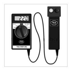
Прибор ТКА-ПКМ-31 предназначен для измерения освещённости в видимой области спектра 380...760 нм и энергетической освещённости в области спектра 280...400 нм — УФ-(A+B).
