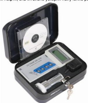
Весь процесс измерения автоматизирован, оператору достаточно заполнить бензином датчик, включить октанометр и записать результат, отображаемый на индикаторе. Прибор прост в эксплуатации, не требует дополнительной настройки и ухода.
