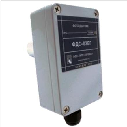
Фотодатчики ФДС-03-БГ и ФДС-03-БГ-У предназначены для контроля наличия/отсутствия пламени основной горелки и выдачи сигнала в схему защиты котла или установки с целью перекрытия подачи топлива на горелочные устройства в случае отсутствия пламени.
