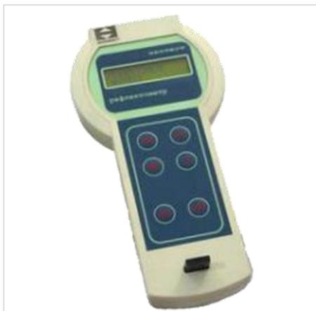
Анализатор Экотест-2040 предназначен для определения коэффициента отражения и концентрации растворов. Может использоваться в химико-технологических, агрохимических, экологических и аналитических лабораториях промышленных предприятий, научно-исследовательских учреждений, органах контроля, инспекции и надзора для анализа природных и сточных вод, технологических растворов и экстрактов проб растительной и пищевой продукции, как в лабораторных, так и в полевых условиях.
