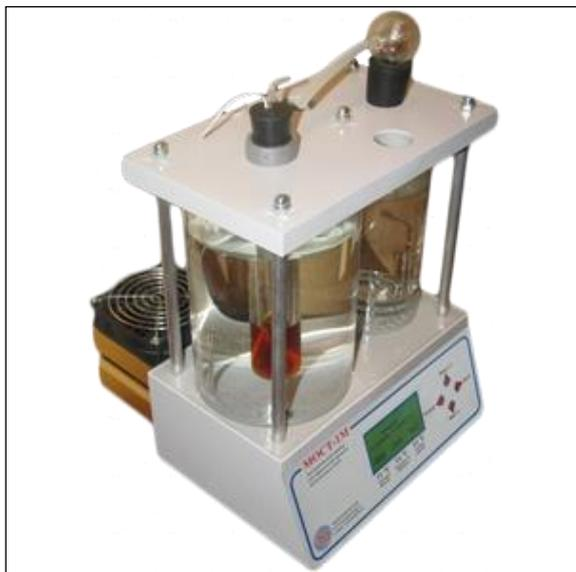
Предназначен для определения времени деэмульсации нефтяных масел. Деэмульсация - процесс, обратный эмульгированию, разрушение эмульсий, т. е. дисперсных систем, состоящих из двух несмешивающихся жидкостей, одна из которых в виде мелких капель равномерно распределена в объеме другой. Капли эмульсии при деэмульсации укрупняются вследствие коалесценции (слияния) в процессе броуновского движения.
