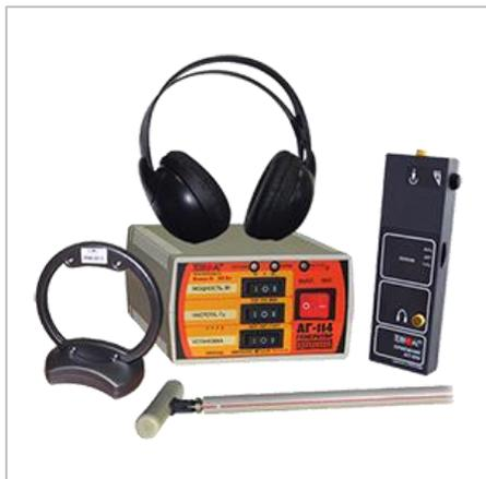
Комплект трассопоисковый Успех-АГ-401 предназначен для определения местоположения и глубины залегания скрытых коммуникаций (силовые и сигнальные кабели, трубопроводы) на глубине до 5 м и удалении до 3 км от места подключения генератора, определения мест повреждения кабельных линий, обследования участков местности перед проведением земляных работ, проведения работ по поиску скрытой проводки.
