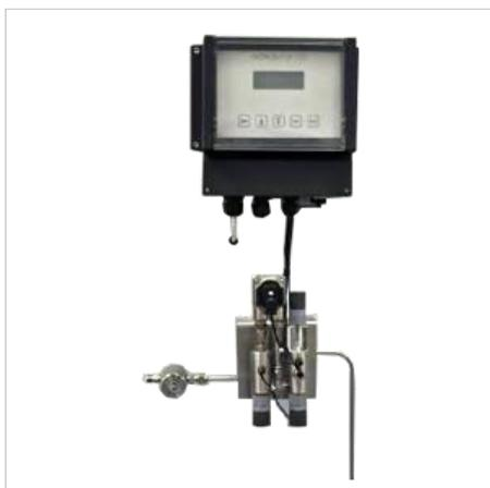
Анализатор водорода HYDROLYT-LP100 предназначен для автоматического непрерывного определения концентрации водорода в водной среде. Он используется, главным образом, для измерения остаточного водорода в паре и питательной воде парогенераторов электростанций или контроля концентрации водорода в первичном контуре АЭС. Диапазон измерения варьирует от нескольких микрограмм водорода в литре до уровня насыщения мг/л.
