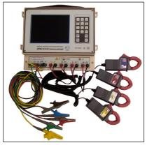
Переносной прибор для контроля показателей качества электроэнергии **ЭРИС-КЭ.04** предназначен для регистрации показателей качества электрической энергии (ПКЭ) в трехфазных электрических сетях общего назначения. Подходит для работы в переносном режиме.
