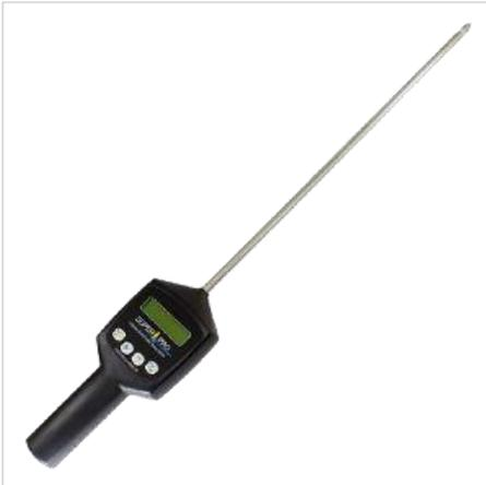
Влагомер-термощуп Superpro Combi предназначен для оперативного измерения влажности и температуры сена и соломы в брикетах, валках, навалом, силосе.
