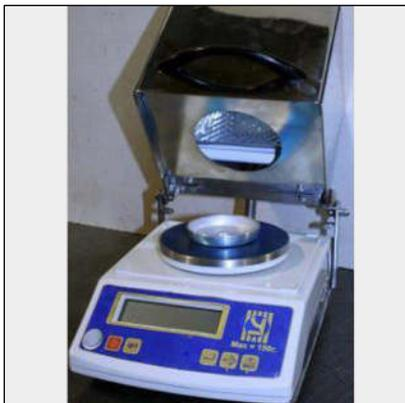
Аппарат для ускоренного определения влажности модели «062М3» состоит из основания, на котором закреплены электронные весы 150/5 (максимальный вес 150г, точность 0,005г).
