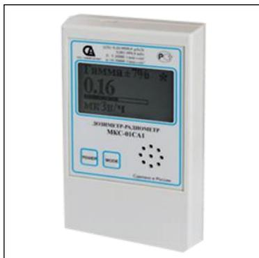
Портативный дозиметр-радиометр МКС-01СА1 предназначен для измерения мощности амбиентной эквивалентной дозы и дозы гамма-(рентгеновского-) излучения, плотности потока бета- и альфа- частиц от загрязненных поверхностей и индикации потока ионизирующих частиц, поиска источников ионизирующего излучения, контроля радиоактивного загрязнения денежных знаков и их упаковок и оперативной оценки радиационной обстановки.
