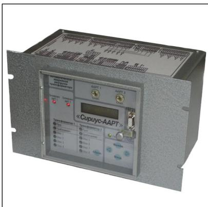
Микропроцессорное устройство автоматической аварийной разгрузки трансформатора «**Сириус-ААРТ**» предназначено для обеспечения защиты от перегрузки трансформаторов путем автоматического отключения ряда потребителей нагрузки в зависимости от тока с учетом тепловой модели трансформатора.
