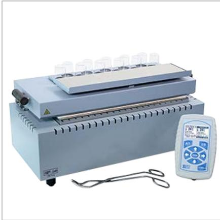
ПДП-Lab двухкамерная программируемая печь, применяемая для выпаривания и озоления проб для их подготовки к дальнейшему анализу.
