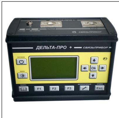
Измеритель **Дельта-ПРО+ VDSL** производит частотный анализ и диагностику линий VDSL, ADSL/ADSL2+, SHDSL, HDSL, E1. Прибор Дельта-ПРО+ VDSL обладает универсальным набором функций для линий, обслуживаемых IP DSLAM и гибкими мультиплексорами (СПМ-14-ЛТ, Zelax и аналоги). Анализатор цифровых каналов и трактов, соответствующих рекомендации ITU-T G.703 на скорости 2048 кбит/с. Рефлектометр высокого разрешения с шумоподавлением и уникально высоким перекрываемым затуханием 96 дБ.
