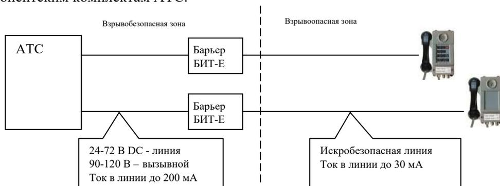
Использование барьеров искрозащиты ограничивает ток в искробезопасной линии до уровня, допустимого по ГОСТ МЭК-60079-11 (максимально допустимый ток короткого замыкания для электрооборудования группы ПС составляет 45,3 мА). Поэтому, даже при замыкании линии во взрывоопасной зоне в результате повреждения линии связи или ошибок персонала при подключении телефонного аппарата не образуется искра, способная воспламенить взрывоопасную смесь.
