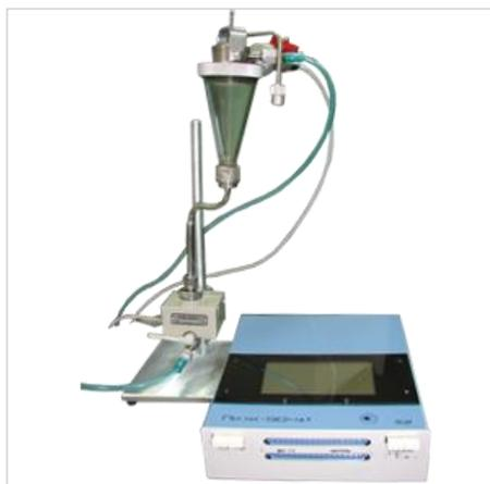
Прибор ПКЖ-904А.1 предназначен для измерения количества частиц, содержащихся в контролируемом объеме жидкости, в диапазоне размеров 5-300 мкм.
