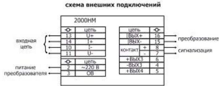
схема подключения 2000NM и термопары с барьерами искрозащиты
