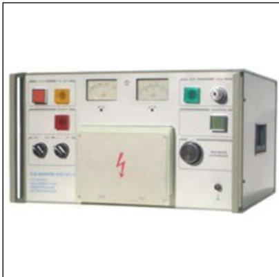
Высоковольтные измерительные (испытательные) установки «УПУ-21», «УПУ-21/1», «УПУ-21/2» предназначены для испытания электрической прочности изоляции напряжением постоянного или переменного тока, а также для оценки тока утечки изоляции испытываемых объектов по постоянному току.
