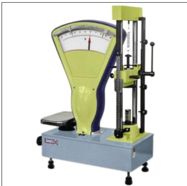
Машина для испытания пружин для нагрузок до 0,1кН применяется для статических испытаний винтовых цилиндрических пружин на сжатие и растяжение и плоских пружин на двухопорный и консольный изгиб, а также для их разбраковки.
