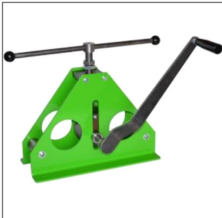
Профилегиб ручной ПГ эконом класса применяется для гибки прямоугольной профильной трубы сечением до 40x40 мм, полосы, прутка, круглой трубы диаметром до 38 мм.
