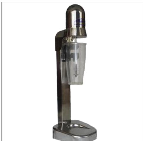
Предназначен для определения глинистой составляющей по ГОСТ 23409.18-78 и для приготовления суспензий и растворов в лабораториях формовочных материалов литейных цехов, центральных заводских лабораториях и научно-исследовательских организациях.
