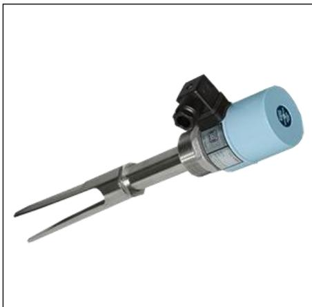
Сигнализаторы уровня серии СКАТ для сыпучих материалов относятся к классу вибрационных датчиков уровня. В настоящее время вибрационные датчики признаны наиболее надежными для решения задач контроля уровня сыпучих (песок, цемент, мука, зерно, шроты, комбикорма), гранулообразных (отсевы, гранулы, дробь, окатыши), кусковых материалов (щебенка, гравий, агломерат), пыли, опила, торфа, химических порошков и т.д.
