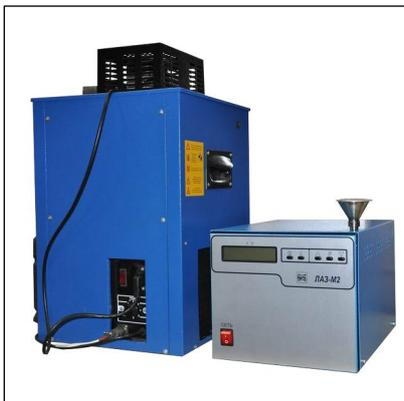
Аппарат **ЛАЗ-М2** предназначен для контроля качества нефтепродуктов и позволяет автоматизировать определение температуры помутнения (ГОСТ 5066 и ASTM D2500) и определение температуры застывания дизельных топлив (ГОСТ 20287, метод Б и ASTM D97).
