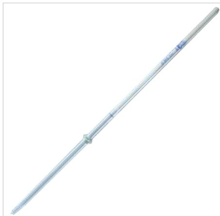
Пипетки Мора с одной меткой предназначены для отмеривания определенного объема жидкости.
