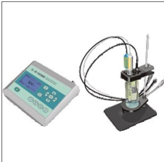
Предназначен для прямого и косвенного потенциометрического измерения активности ионов водорода (рН), активности и концентрации других одновалентных и двухвалентных анионов и катионов (рХ), окислительно-восстановительных потенциалов (Еh) и температуры в водных растворах с представлением результатов в цифровой форме и в виде аналогового сигнала напряжения постоянного тока.
