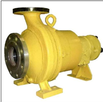
Центробежные, горизонтальные, одноступенчатые, герметичные насосные агрегаты серии ЦГ (ЦГ 50-32-200, ЦГ 65-40-200, ЦГ 80-50-200) предназначены для перекачивания жидкостей с плотностью не более  $1,35 \text{ г/см}^3$  и температурой от  $-40^\circ\text{C}$  до  $+100^\circ\text{C}$ , пары и газы которых могут образовывать с воздухом взрывоопасные смеси, категорий IIA и IIB групп T1, T2, T3, T4 по ГОСТ 12.1.011-78.
