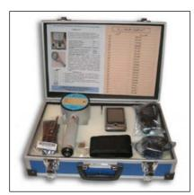
Портативный акустический уровнемер «АКВА-01» предназначен для измерения статического и динамичного уровней воды в артезианских и наблюдательных скважинах, а также для работы в составе разветвленных систем мониторинга уровня подземных вод с целью определения запасов пресной воды, предупреждения возможных подтоплений, наводнений и других чрезвычайных ситуаций.
