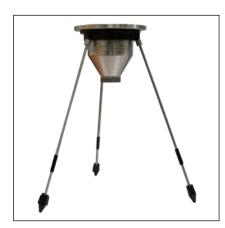
Вискозиметр Константа-В3-DIN53211-№4 предназначен для определения условной вязкости (времени истечения) лакокрасочных материалов и относящихся к ним продуктов – ньютоновских или приближающихся к ним жидкостей.
